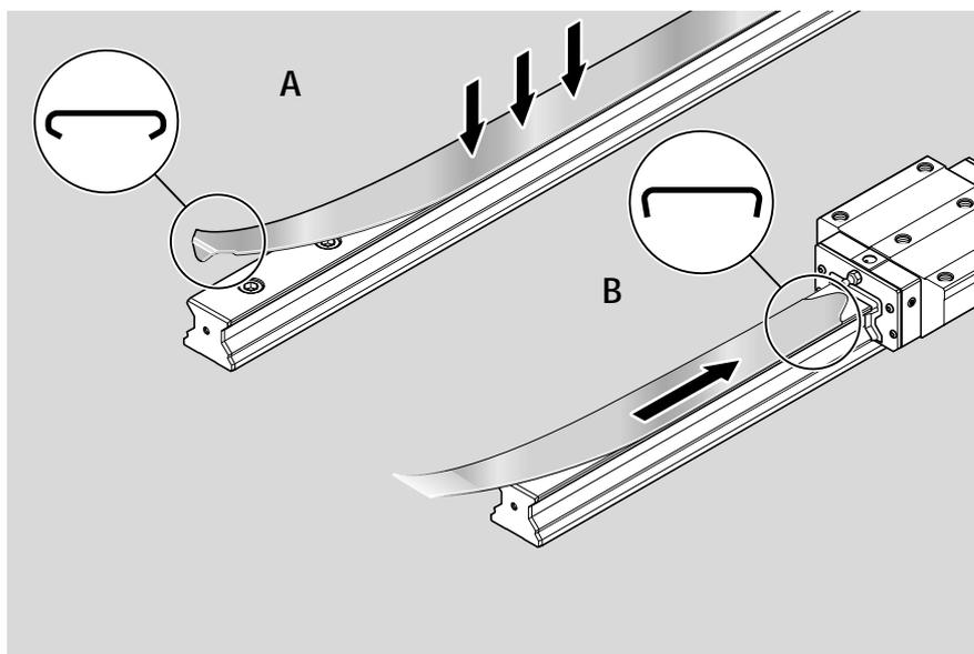
Может использоваться специальный инструмент для распрямления защитных лент для создания скользящей подгонки после установки, чтобы защитную ленту можно было удалять.
