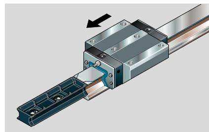
**⚠** Для снятия каретки с рельса снова используйте монтажную оправку! Если каретки не установлены на направляющих рельсах, они всегда должны находиться на оправке!
