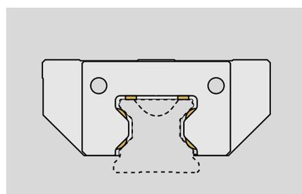
Особая конструкция распределительных каналов гарантирует применение смазки только там, где она нужна: непосредственно к роликовым каналам и к поверхности направляющего рельса.
