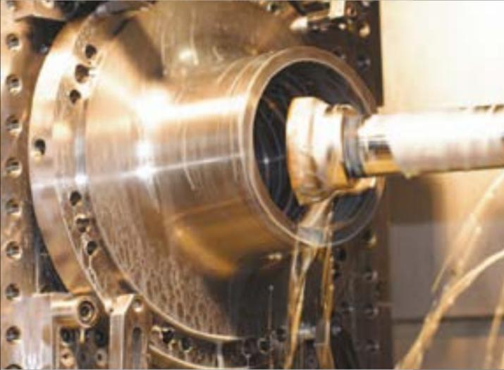
Тяжелые режимы резания при фрезеровании
