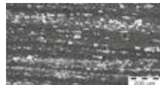
Микроструктура обычной 12% хромистой стали
